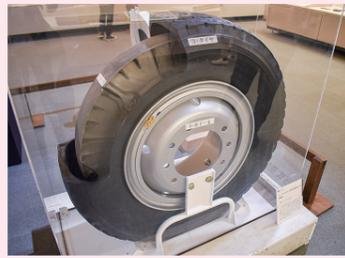
シーサイドラインの中子式タイヤは、万一パンクしても安全に走行できるよう、中に「中子」という鉄の車輪が入っている
