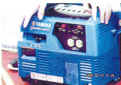
ガス式発電機
