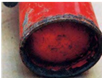
錆や塗装の剥離
