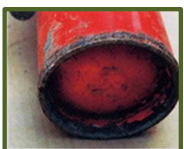
錆や塗装の剥離
