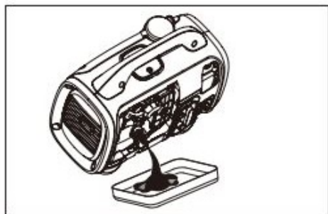
5. 本機を傾けてエンジンオイルを排出してください。
