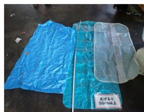
破袋機を通らず、隙間に噛み込んだ、もしくは破袋機に巻き付き、機器の復旧に時間を要したものの。
