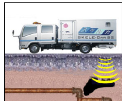
空洞探査車による調査(一次調査)
