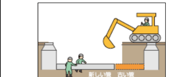
大きい管へ入れ替える開削工法のイメージ
